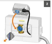
Entfernen Sie den Griff und setzen Sie den elektrischen Stellantrieb €100 mit leichtem Druck in den Ventilsitz ein.
