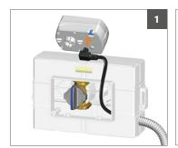
Stecken Sie das vorbereitete Kabel mit dem Stecker in den elektrischen Stellantrieb €100.
