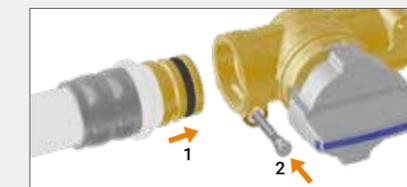
1. Insérer le raccord avec la goupille relevée.
