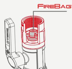
**i** Le valvole con i dispositivi di sicurezza vanno montate a monte del contatore.
