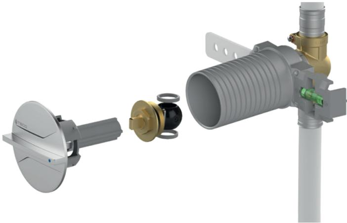
ULTRA ist ein kompaktes Absperrventil. Volldurchgang, gemäß EN 806-2. Wandbündiger Einbau mit tiefenverstellbare T-Box. Betätigungszubehör wandbündig mit minimalen Abmessungen. Demontierbare TOP-ENTRY®-Absperrungen mit Kugeln mit Antiblockierschutz Soft Turn®. Die FASTEC®-Verbindung ermöglicht komfortables und sicheres Arbeiten.
