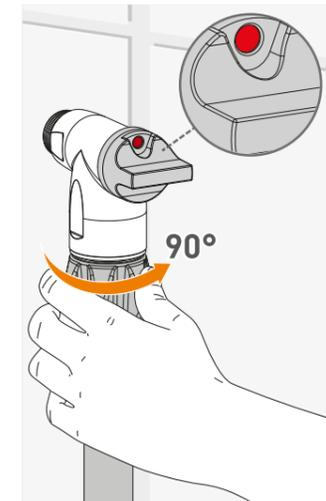
Durch Drehen des Rohrgriffs um 90° bleibt dieses am Ventil blockiert. Das Ventil kann nur in dieser Position geöffnet werden.
