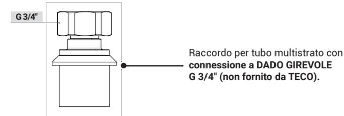
Raccordo per tubo multistrato con connessione a DADO GIREVOLE G 3/4" (non fornito da TECO).
