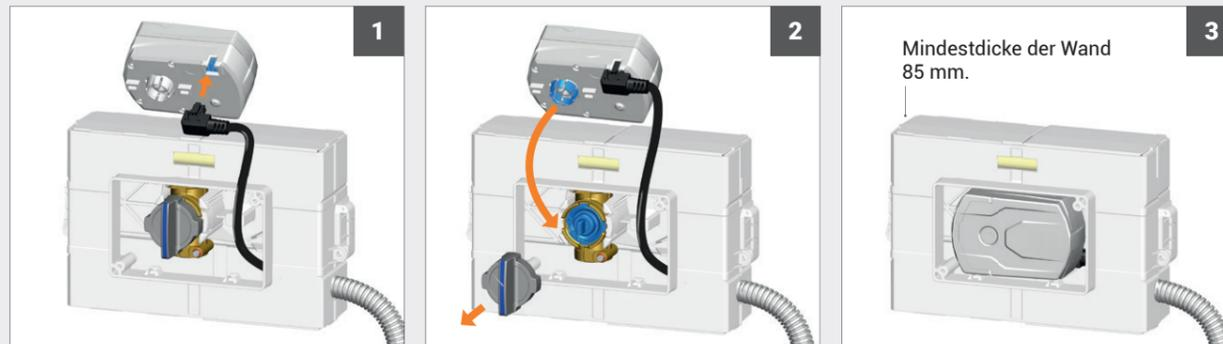
1 Stecken Sie das vorbereitete Kabel mit dem Stecker in den Elektroantrieb €100.
