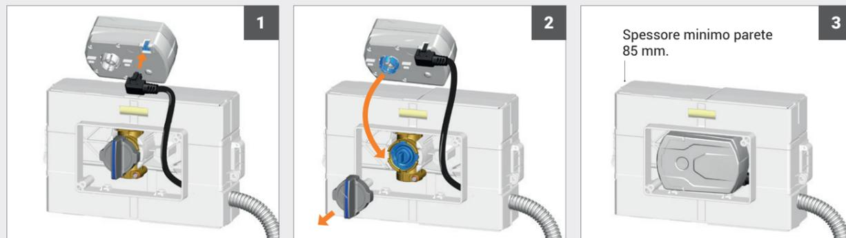
1 Inserire il cavo predisposto con il connettore nell'attuatore elettrico €100.
