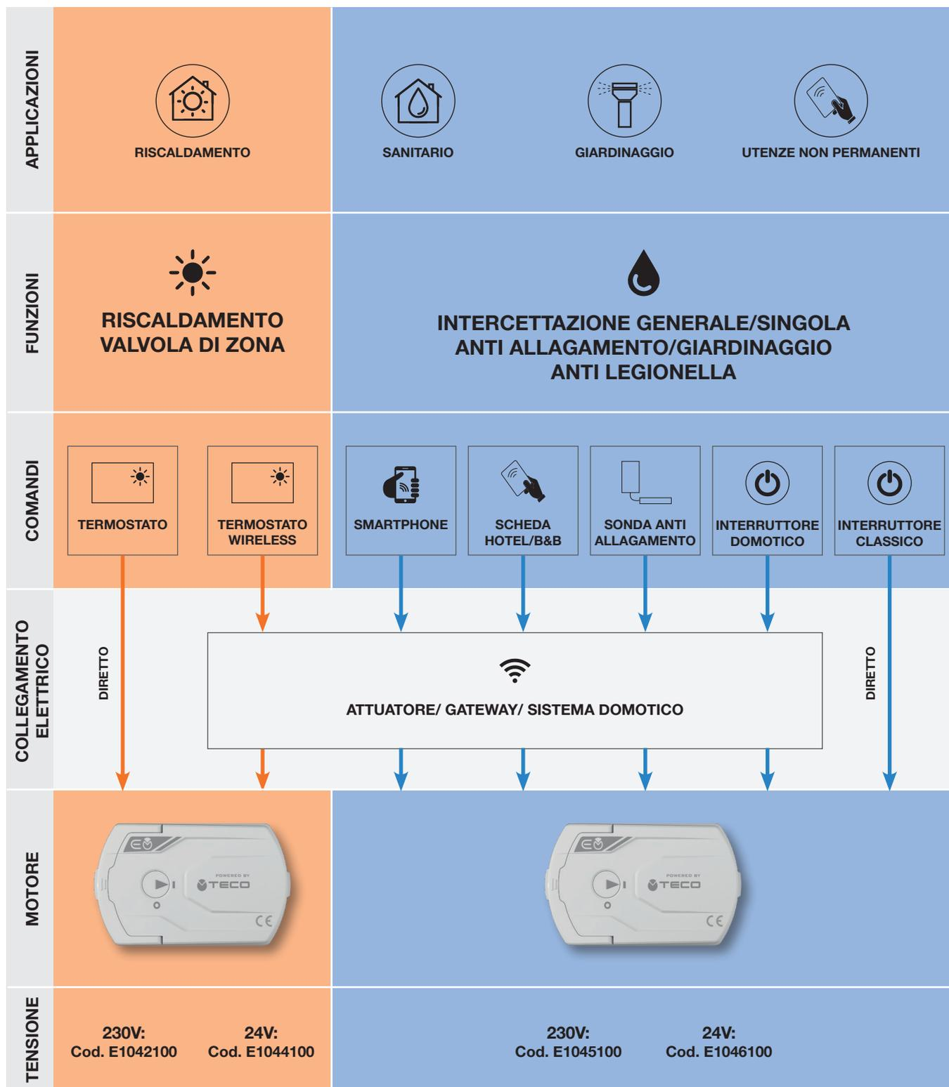
Motore ON/OFF con microinterruttore ausiliario per gestire l'attivazione del generatore a valvola aperta.
